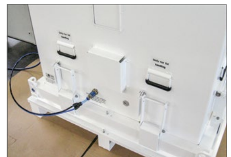
Wasserdampfdichter Behälter bei Dichtheitsprüfung durch Überdruck
