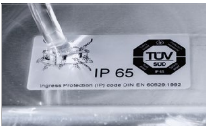
Strahlwasserschutz nach Norm IP 65
